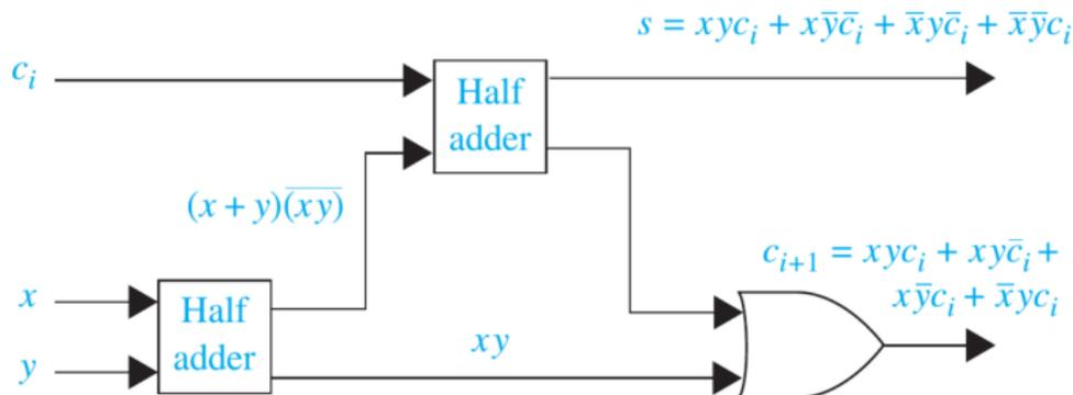
Note que poderíamos ter construído o somador completo diretamente a partir das fórmulas derivadas para  $s$  e  $c_{i+1}$ , mas optamos por uma forma equivalente usando meio-somadores, que é um componente que já projetamos. (Desafio: você pode checar que a implementação é equivalente usando tabelas da verdade!)
